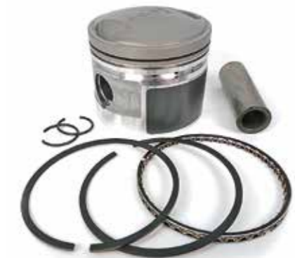
Die neuen Kolben des Russenboxers sind Teflonbeschichtet.
