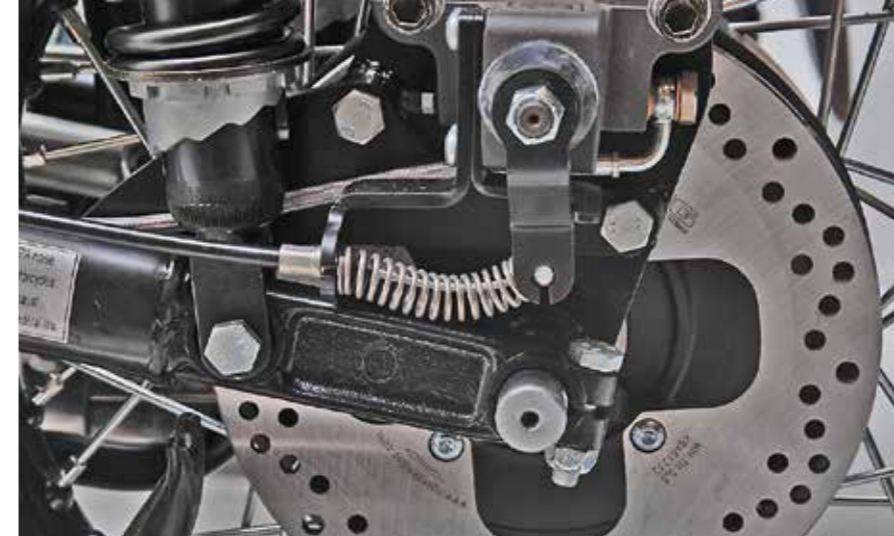
Eine über Seilzug betätigte Feststellbremse wirkt auf den Bremszylinder am Hinterrad.
