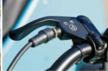
Parking Position: Die Feststellbremse sitzt links am Lenker
