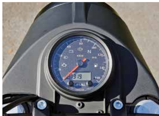
Zweigleisig: Der Ural-Tacho lässt sich von Kilometer- auf Meilenanzeige umschalten
