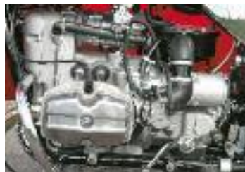
Perestroika: Europäische Teile am archaischen Zweiventil-Boxer
